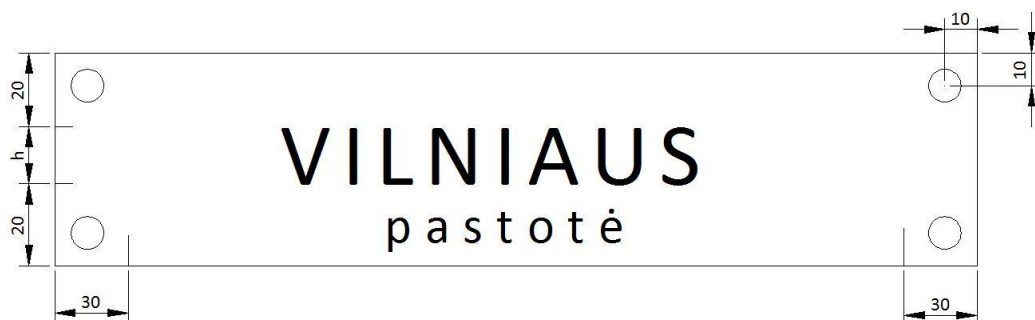
1 pav. 110-330 kV transformatorių pastočių pavadinimo lentelė
